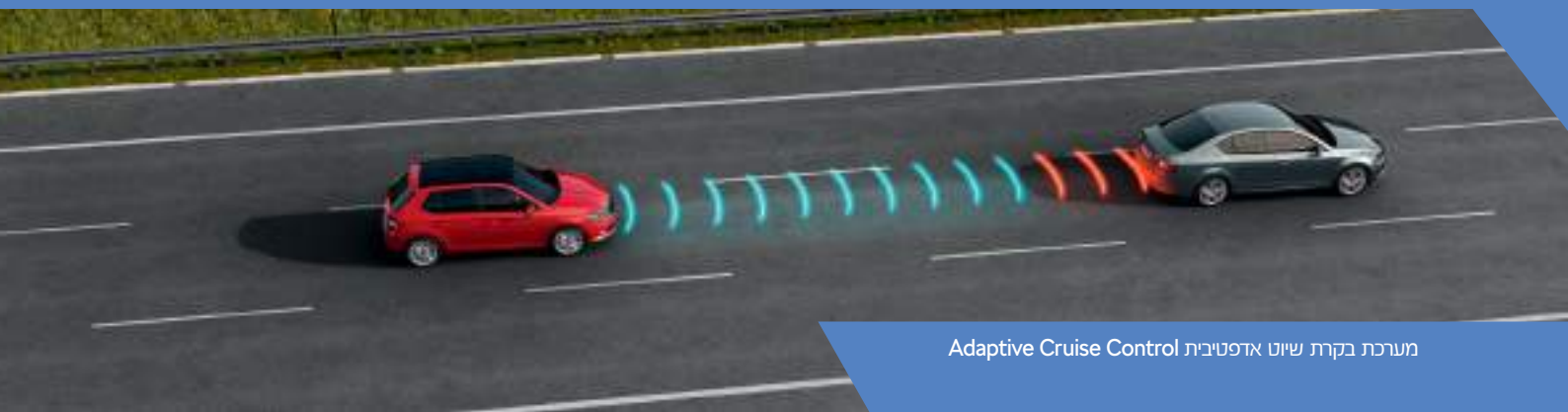
מערכת אקטיבית Front Assist לניטור מרחק מלפנים
