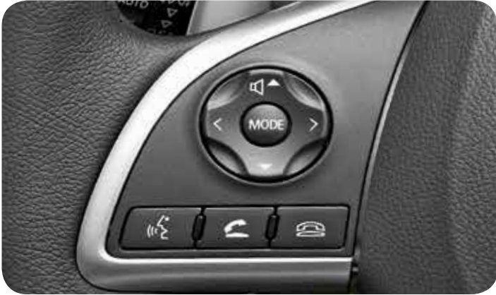
שליטה על מערכת הקול ודיבורית Bluetooth® מגלגל ההגה מתגי שליטה על מערכת השמע והדיבורית ממוקמים על גלגל ההגה לגישה נוחה ומהירה.
