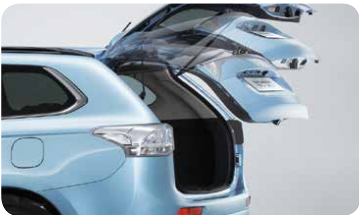
דלת תא מטען חשמלית ניתן לפתוח ולסגור את דלת תא המטען אוטומטית באמצעות כפתור הממוקם ליד מושב הנהג.
